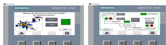
Fig. 3. Pantallas del HMI del Sistema de Fabricación.
